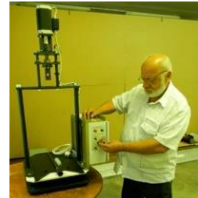
Стенд для испытания электромагнитов СИЭ-2,5
