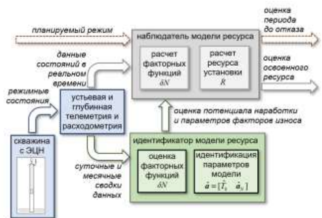
Рис. 1. Функциональная схема оперативного прогноза времени наработки на отказ ЭЦН
