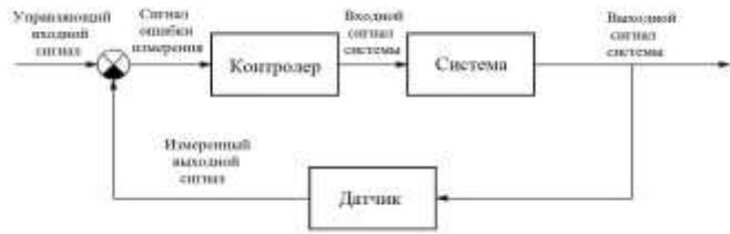
Рис. 2. Система управления АВК-Н Спутник с отрицательной обратной связью
