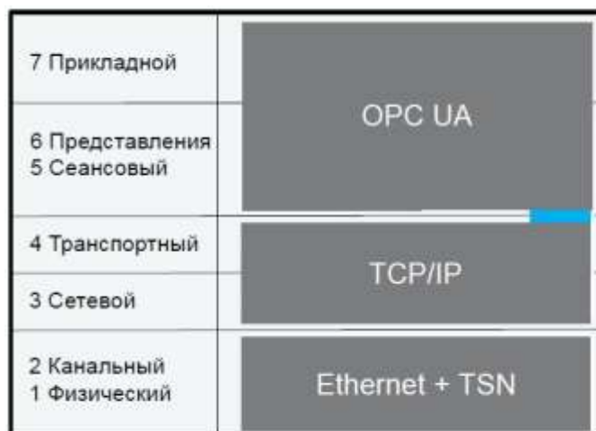
Рис. 3. OPC UA и TSN в модели OSI
