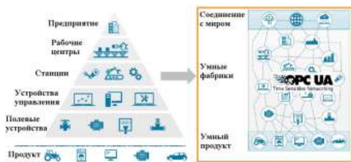
Рис. 1. Промышленный интернет вещей. Переход от иерархической структуры к однородной
