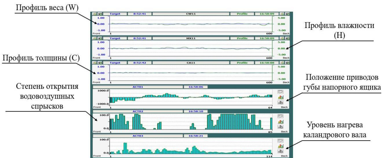
Рис. 2. Пример экрана системы управления профилями бумажного полотна
