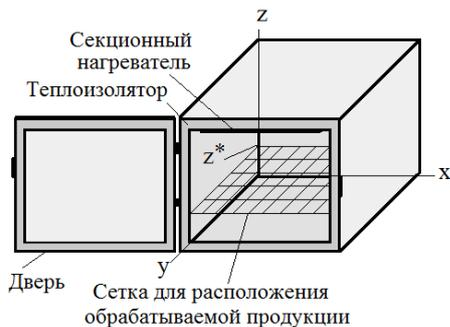
Рис. 1. Нагревательная камера
