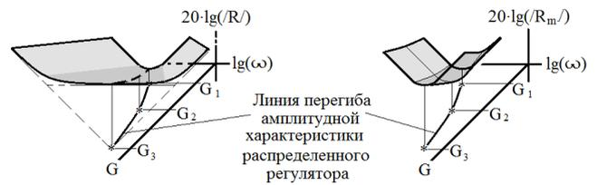
Рис. 5. Амплитудные характеристики регуляторов
