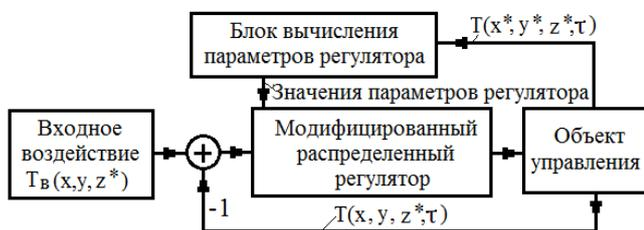
Рис. 7. Структурная схема адаптивной распределенной системы управления
