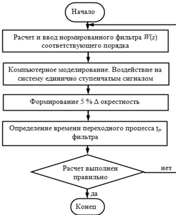
Рис. 1. Блок-схема оценки времени переходного процесса фильтров
