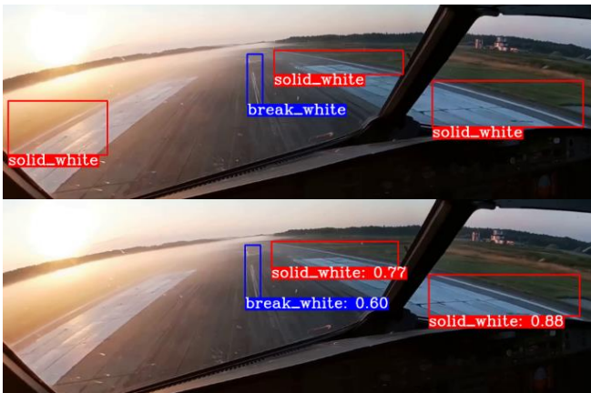
Рис. 9. Пример кадра, на котором модель №2 не смогла определить левую сплошную линию разметки (верхний кадр – целевая разметка, нижний кадр – предсказания модели)
