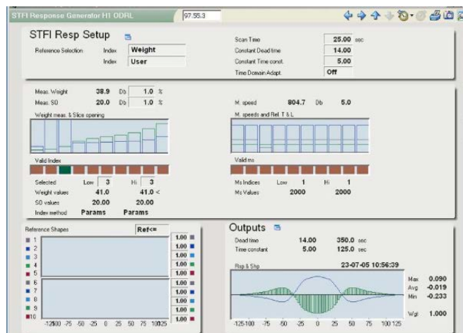
Рис. 1. Пример экрана системы управления весом 1 м 2 бумаги в продольном направлении
