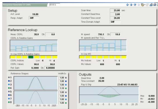
Рис. 3. Пример экрана системы управления толщиной бумаги в продольном направлении
