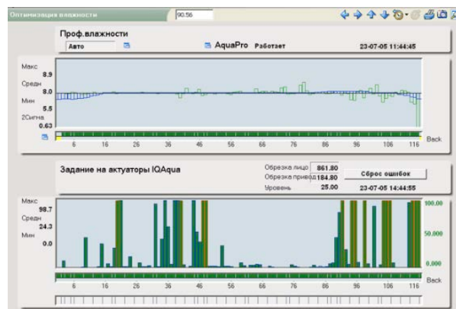
Рис. 5. Пример экрана системы управления влажностью бумаги в поперечном направлении
