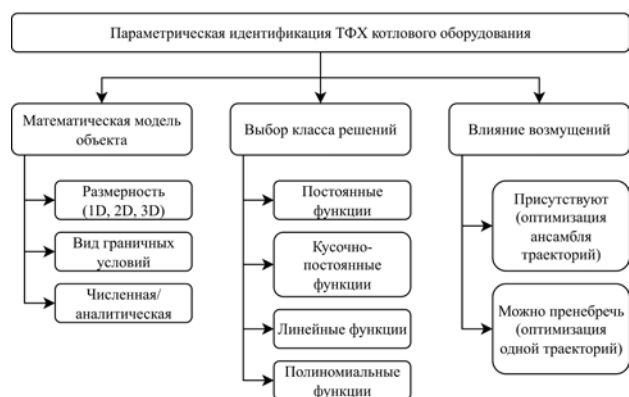
Рис. 2. Основные аспекты при параметрической идентификации теплофизических характеристик (ТФХ)
