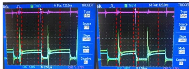
Рис. 4. Осциллограммы влияния переходных процессов на показания АЦП микроконтроллера
