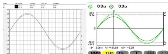
Рис. 9. Осциллограммы выходного напряжения, тока и коэффициента гармоник макетного образца
